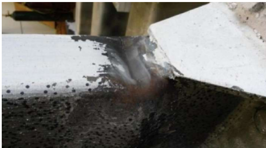
Figura 73. Daños observados en el ensayo experimental 2 de la conexión CX-1.
