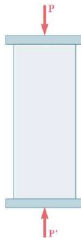
Figura 22. Elemento isótropo y homogéneo cargado axialmente a través de placas rígidas.
