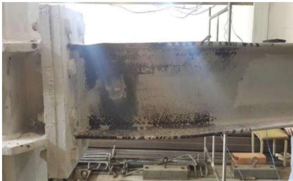
Figura 82. Daños observados en el ensayo experimental 1 de la conexión CX-2.
