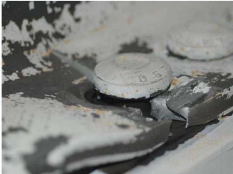
Figura 94. Fractura en el área neta del ala de la viga en la conexión CX-3.
